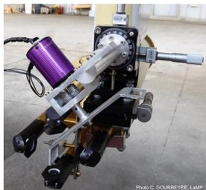
Élément tournant et sonde 2D-S
