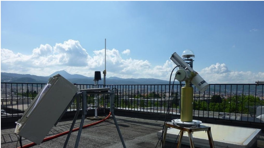
Figure 3-5: Photographie du photomètre CIMEL réalisant une visée directe du soleil.
