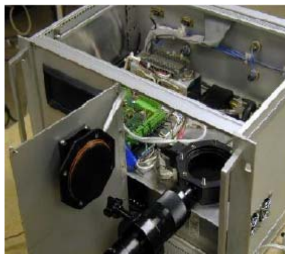
Fig. 2.2.2 : Schéma des principaux composants du système de détection du compteur de CCN.
