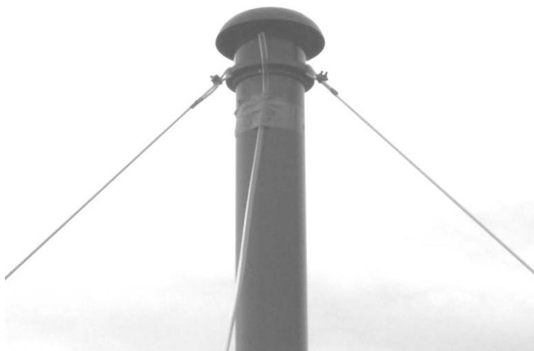
Photo 2.1.3 Tube de prélèvement et tête d'entrée du WAI
