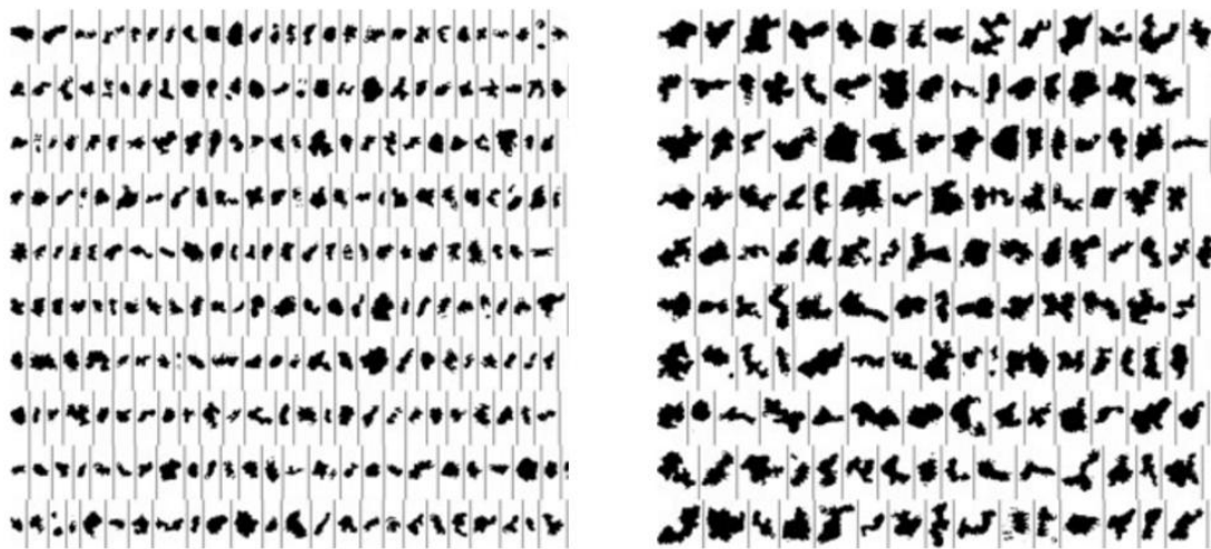
Figure 3-2 : Exemples d'images des particules glacées obtenues grâce aux sondes microphysiques CIP et PIP de la campagne Megha-Tropiques 2010 de Niamey. À gauche : D_{\max} compris entre 20 et 40 pixels. À droite : D_{\max} > 40 pixels.
